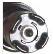
광범위한 pH 유리 전극 (HF-resistant 유리 전극도 사용 가능)
